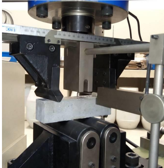
Figura 36 – Equipamento utilizado no ensaio de flexão de vigas.
