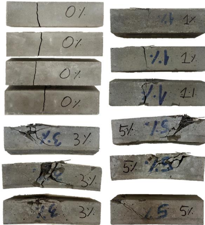
Figura 110 – Corpos de prova após tratamento térmico e ensaio de flexão
