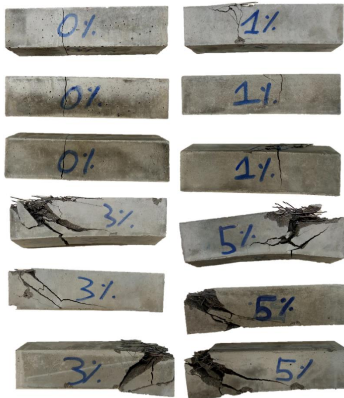
Figura 109 – Corpos de prova sem tratamento térmico, após ensaio de flexão.
