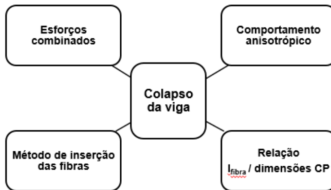
Figura 116 – Fatores influentes para o colapso da viga e padrão de fissuras.
